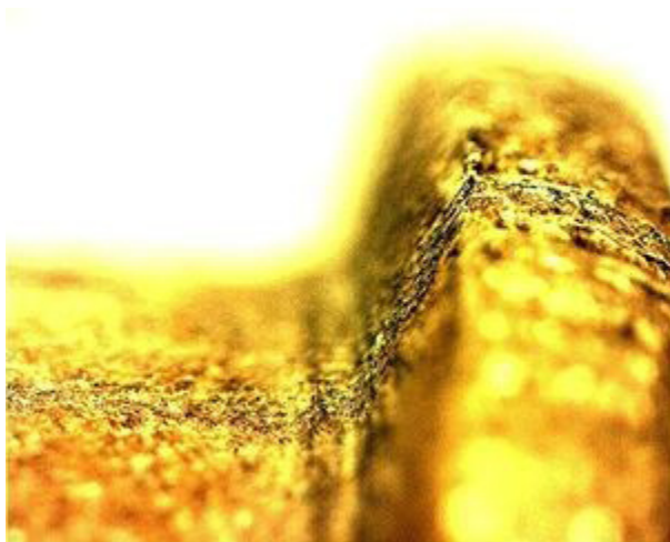
Figura 3. Pieza 2 de aleación de cobre. Zona de unión por soldadura.
