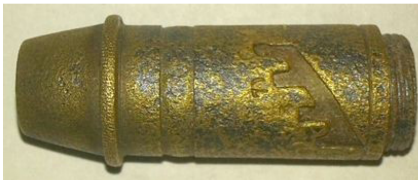
Figura 1. Muestra 2 Pieza compuesta de aleación de cobre
