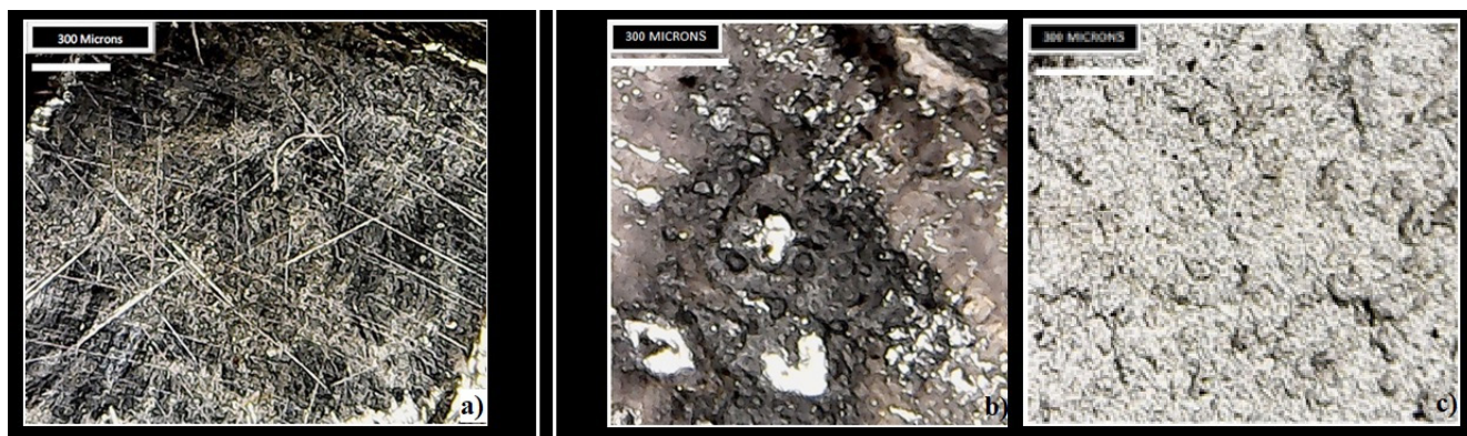
Figura 5. Micrografías de muestras tomadas de la Bell en estado como “recibido” (a) y después de un calentamiento durante la TGA hasta 800°C (b y c).
