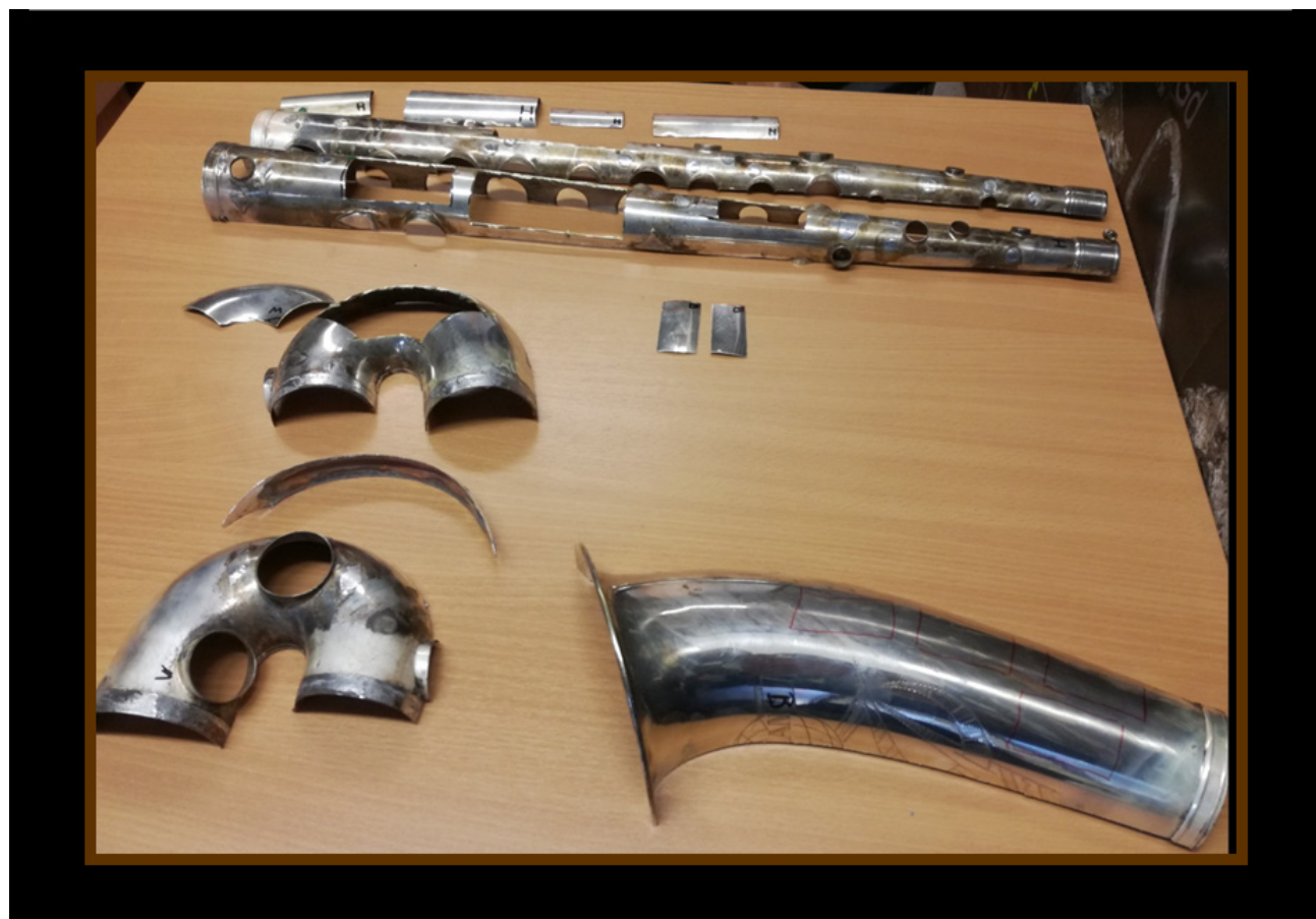
Figura 2. Vista de los cortes de las secciones del instrumento para posterior extracción de las muestras.
